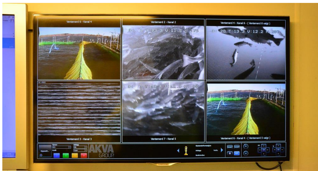
Figur 10 Overvåking av trengeprosessen på ventemerd blant annet ved bruk av kameraer plassert over og under vann.
