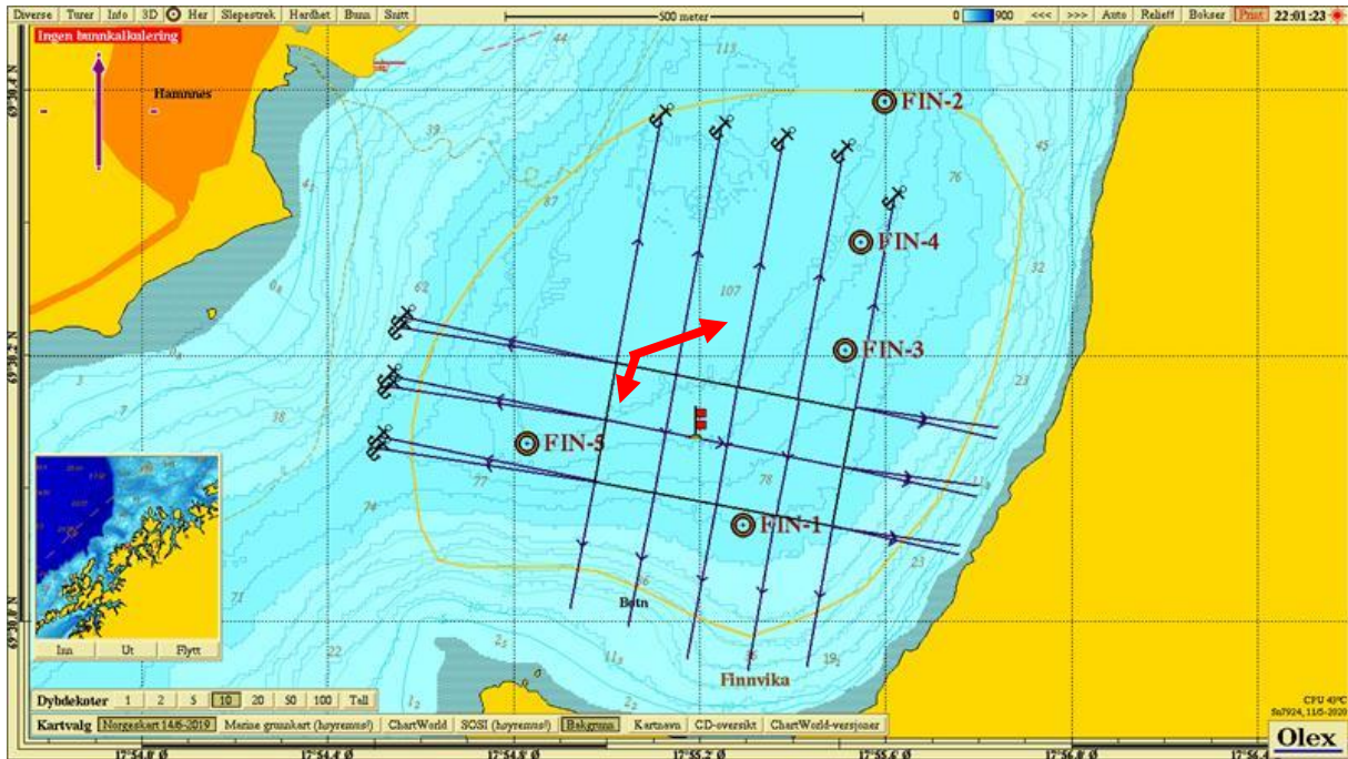
Figur 2.1.3 Plassering av anleggsramme og fortløyningslinjer med bunntopografi, målepunkt for strømundersøkelse (flagg), prøvestasjonsplassering (brune rundinger), og antatt utstrekning av overgangssonen (gul linje). Rød pil angir hovedretning for spredningsstrøm (relativ fluks). Kartet har nordlig orientering og mørkere blå farge representerer dypere områder. Kartdatum WGS84.
